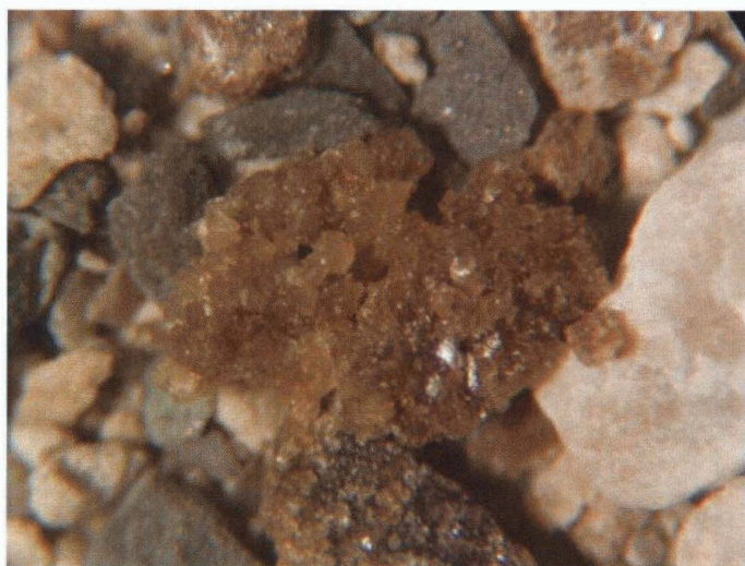
1420m, Sulphur Pt dol, med xl and vugs, 60X
