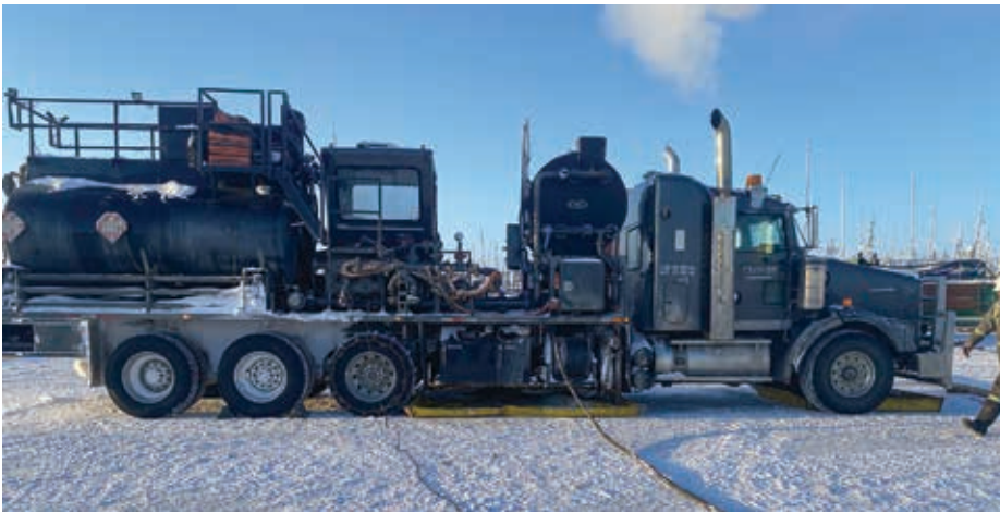
Unité d'injection d'huile chaude et injecteur de méthanol près de Colville Lake, en mars 2026. (BOROPG)
