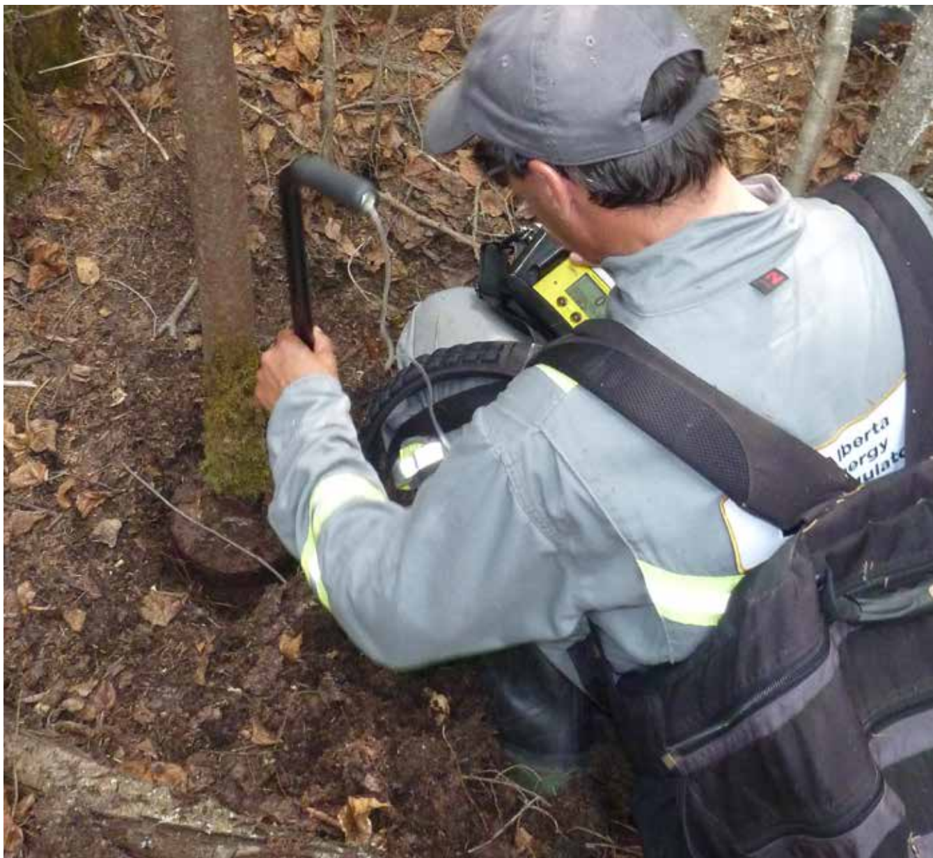
Al Duben, spécialiste de surveillance de la qualité de l'air auprès de l'organisme de réglementation de l'énergie de l'Alberta, utilise ici un détecteur de méthane portatif pour détecter toute fuite de gaz provenant d'un puits abandonné. (BOROPG)
